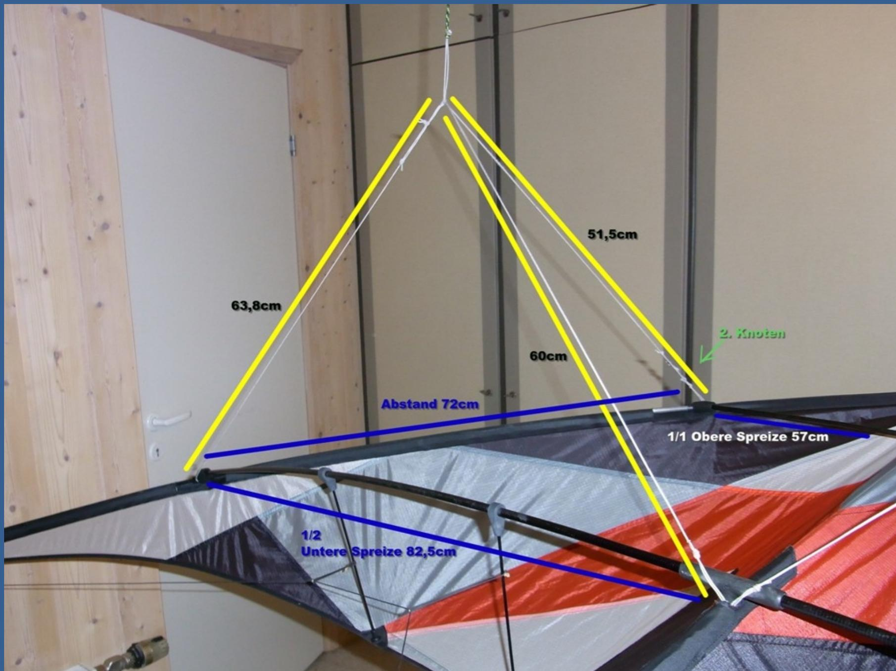
Die Standard-Dreipunktwaage ist hier optimal, da ein besserer Windbereich in Richtung 1Bft und weniger erreicht werden kann.
